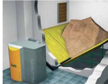
Beispiel für einen Pelletgeraum Foto: ÖkofEN, Lembach Österreich
